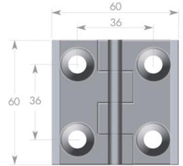
Alle Scharnier-Ausführungen in Zinkdruckguss oder in Edelstahl erhältlich!
