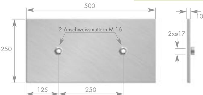
Stahlplatte mit zwei Bohrungen und zwei aufgeschweißten Muttern.
