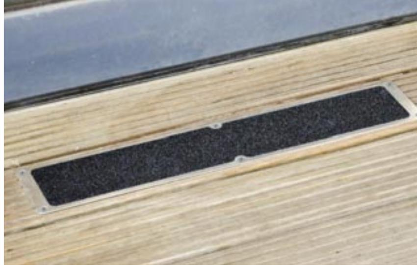
**D**ie Antirutsch-Aluminiumplatten eignen sich speziell für schwierige Untergründe wie z.B. Holz, Gitterroste und Teppiche. Die 1,5 mm starke, flache Aluminiumplatte ist mit vorgebohrten Löchern versehen. Die Antirutschoberfläche kann je nach Typ ausgewählt werden.
